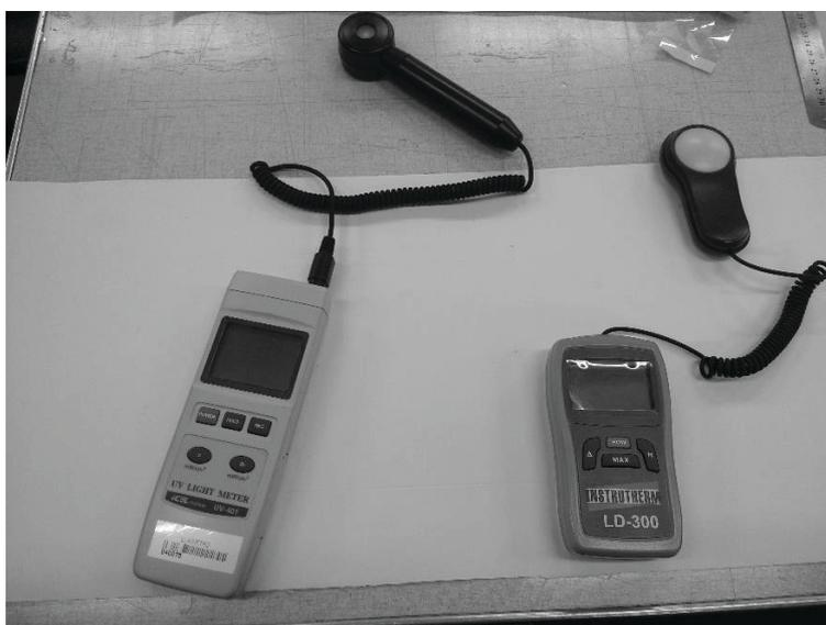
Figura 9 - À esquerda (branco), o aparelho medidor de luz UV; à direita (vermelho), o aparelho medidor de Lux.
