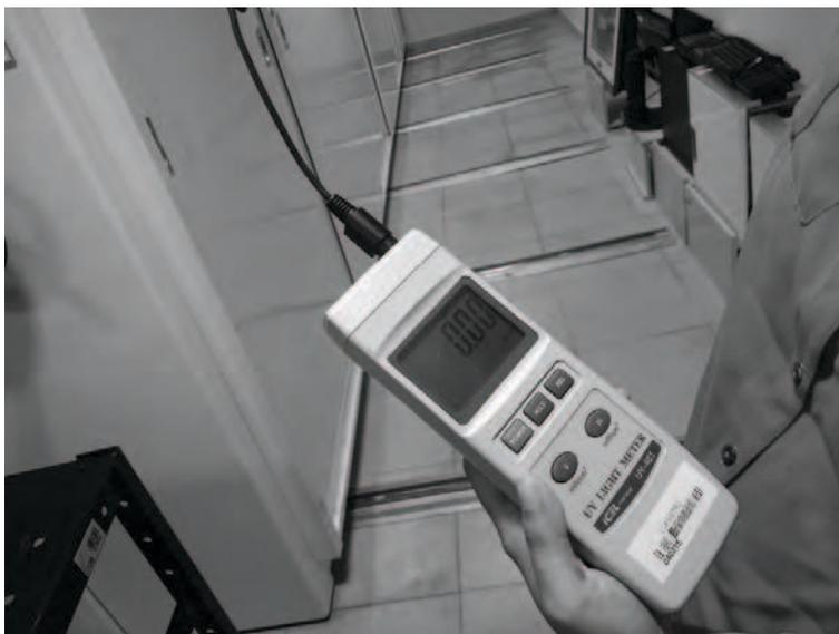
Figura 11 - Medição de radiação ultravioleta.
