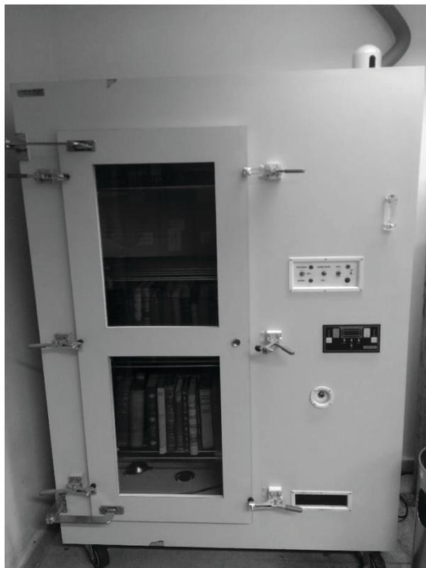
Figura 12 - Câmara de desinfestação.
