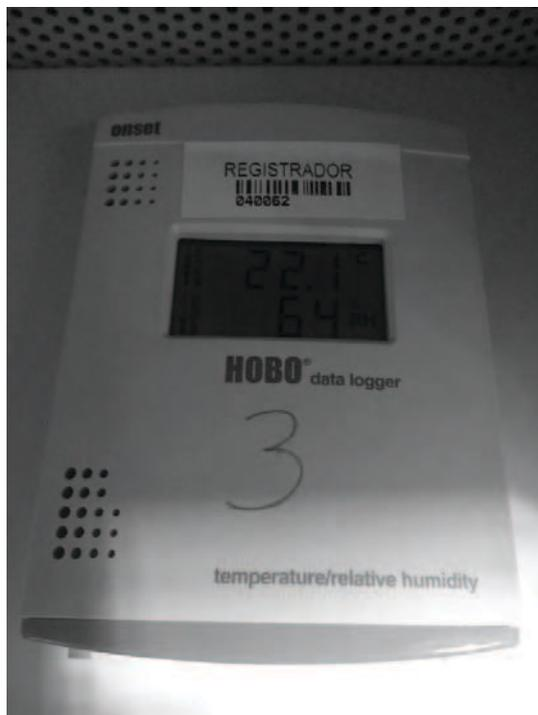
Figura 7 - *Datalogger* localizado na sala da Biblioteca, medindo a temperatura e a Humidade Relativa.
