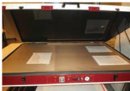
Fig. 14. Laminación de varios Bifolios con Papel Archibond en la Mesa de Calor y Vacío.
