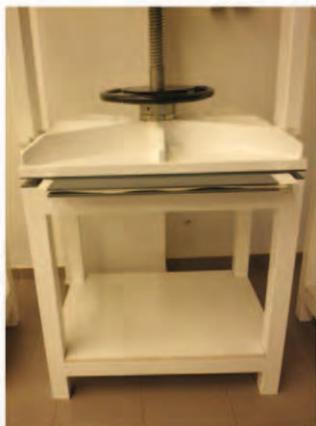
Fig. 9. Secado y alisado de los Bifolios tras el baño, colocándolos entre Papeles Secantes y bajo presión en la Prensa del Taller.
