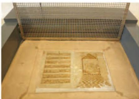
Fig. 11. Reintegración de soporte con Pulpa de papel en la Reintegradora Mecánica.
