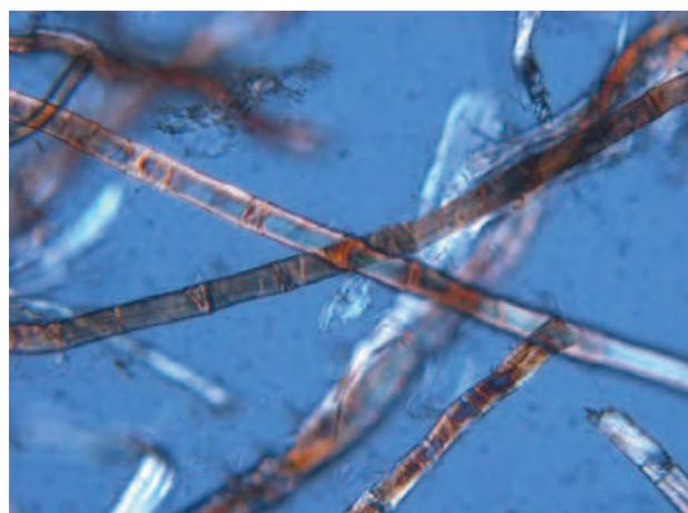
Figura 7. Fibras papeleras de lino o cáñamo, microscopio óptico con luz polarizada, 200X
