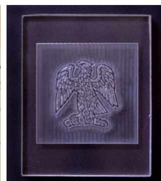
Figura 15, 16 y 17 Diseño de la marca de agua del billete de 50 euros. Imagen del “grabado digital” junto a la primera marca de agua diseñada de esta forma.
