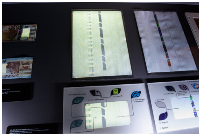
Figura 7.1 y 7.2 Detalle del diseño del billete “Lince” y las características de seguridad de este billete.
