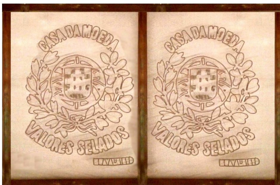
Figura 5 – filigranas de arame de cobre usadas na produção de marcas d'água para papel selado na fábrica de Porto de Cavaleiros; as filigranas fixavam-se aos pontusais da forma e a papa de fibras de celulose assentava sobre elas ficando a marca d'água desenhada no papel (imagem por cortesia do Museu do Papel)
