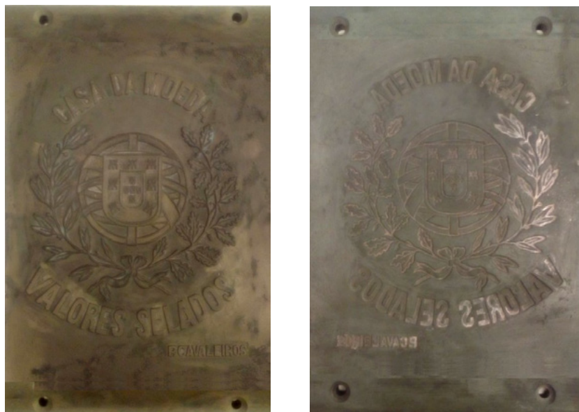
Figura 6 e 7 – um método mais recente consistia na cravagem das marcas d'água enquanto o papel ainda não tinha secado; vemos acima o cunho e contra-cunho da marca d'água para o papel selado fabricado em Porto de Cavaleiros (imagens por cortesia do Museu do Papel)
