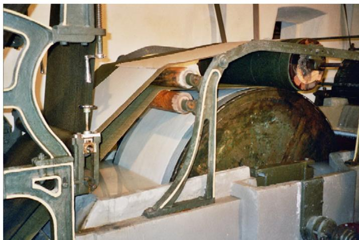
**Figura 7** Formación de la hoja en la parte central de la máquina: tambor formador, rodillo ponedor, bayetas y rodillos (Diciembre 2002).
