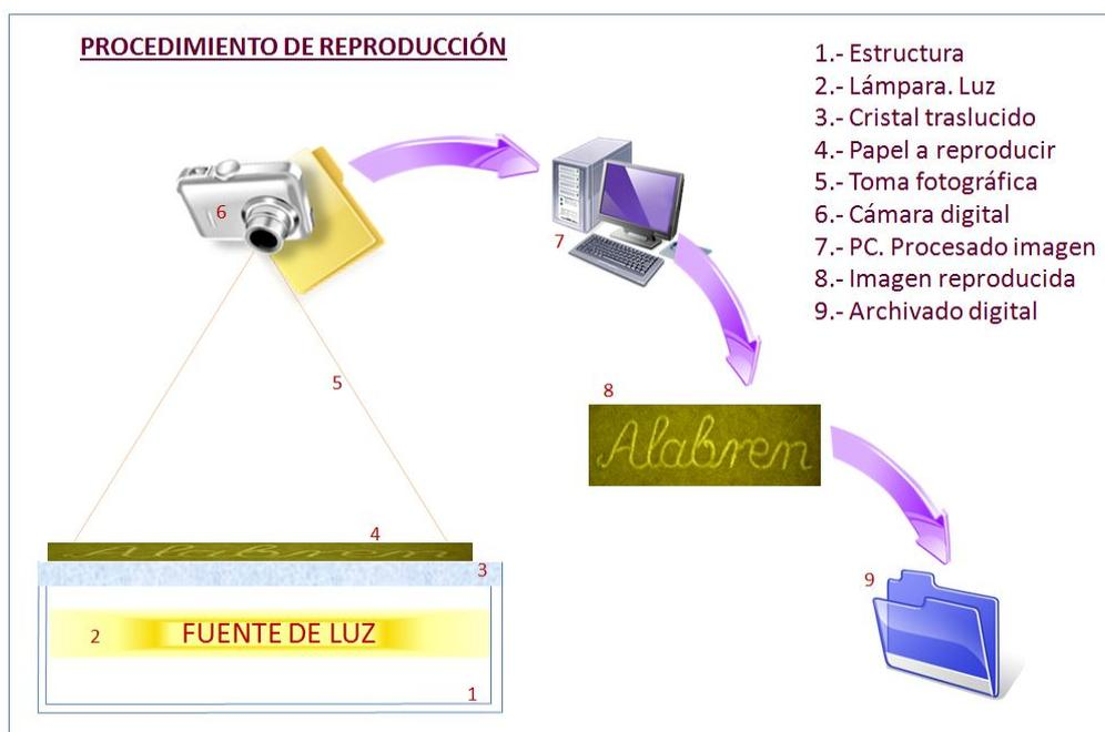
Las tomas fotográficas almacenadas en la memoria de la cámara digital, se transfieren al PC, en el cual se procesa y archiva cada marca en una carpeta con el nombre y numeración anteriormente asignados. El procesamiento de imágenes mediante el PC permite, entre otras posibilidades, ampliar ó reducir tamaños de la fotografía, lo que facilita el poder detectar detalles en las marcas al agua complicadas de identificar y que a tamaños y condiciones normales resultarían difíciles de visualizar.
