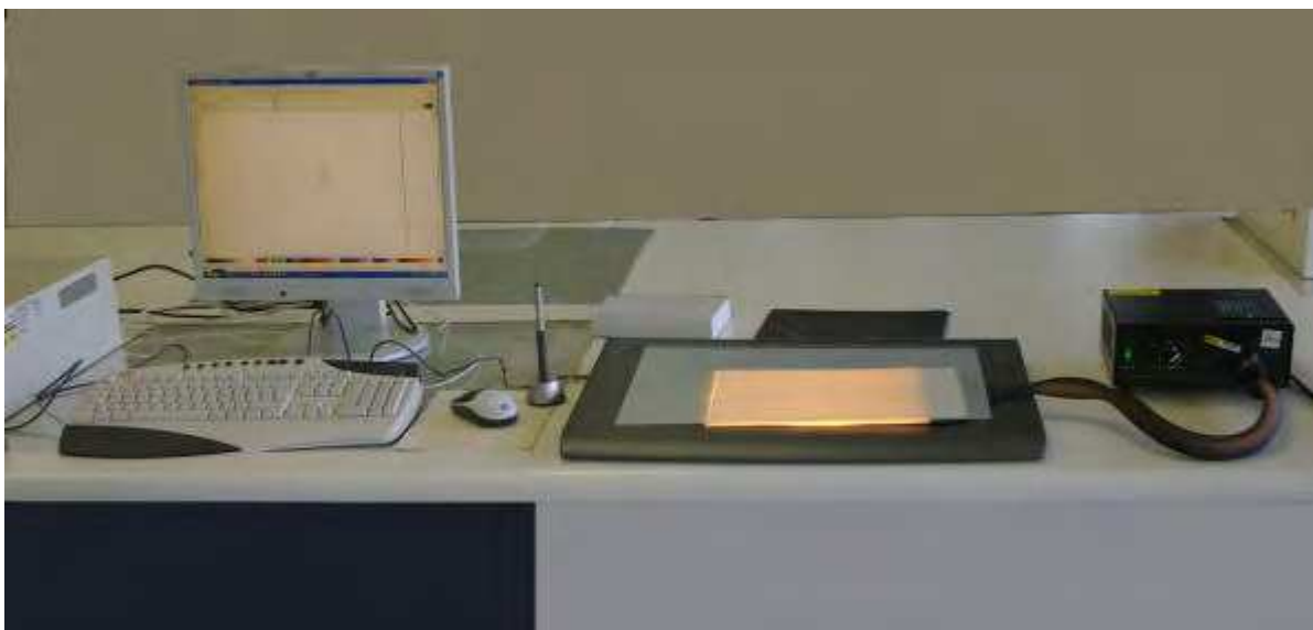
Ilustración Nº 15: Documento con la filigrana sobre una hoja de luz fría colocada sobre una tableta digital, conectada a un ordenador. En la pantalla del ordenador se visualiza el programa Inkscape.
