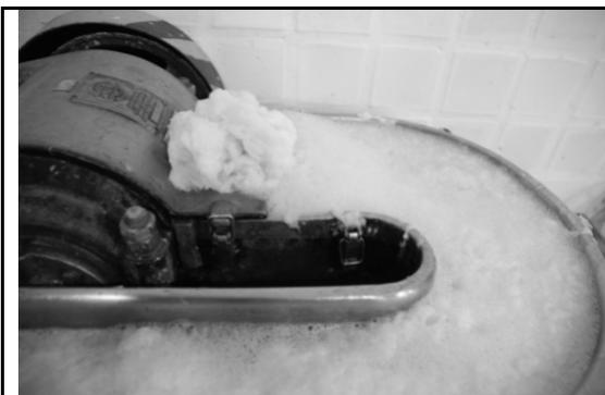
Figura 9. Pila holandesa con capacidad para 1kg de pasta seca
