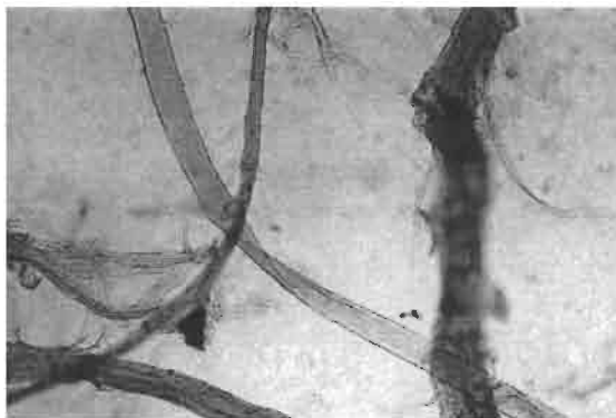
Vistas de fibra del papel con reactivo "C" (algodón) en microscopio 58 X
