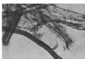
Figura 2. Fibras teñidas con reactivo Lofton-Meritt de un papel con filigrana.
